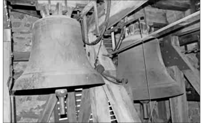
Zu sehen ist hier das Hammerwerk, das auf die 11-Uhr-Glocke (links) schlägt und den Ton des Viertelstundenschlages ausführt. Die rechte 12-Uhr-Glocke schlägt das Hammerwerk zur vollen Stunde.
